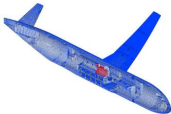
Fig. 3 – FEM solid mesh
